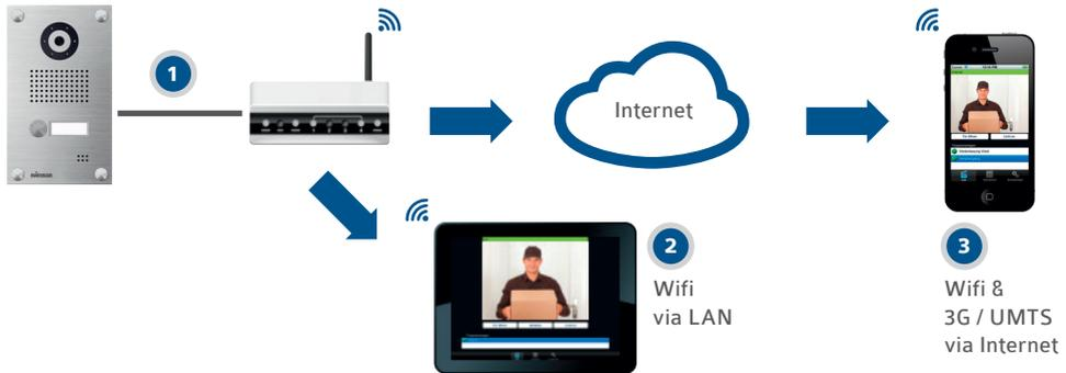
Die Türsprechanlage wird mit dem Stromnetz (12-15 V Stecker- oder Hutschienennetzteil) und per Netzkabel **1** mit Ihrem Router verbunden. Der Sprechverkehr und das Kamerabild werden vom Router auf iPhone, iPad und Android-Geräte übertragen, zuhause im lokalen Netzwerk (LAN) **2** und unterwegs via Internet (WAN) oder UMTS ohne Reichweitenbegrenzung **3**.
