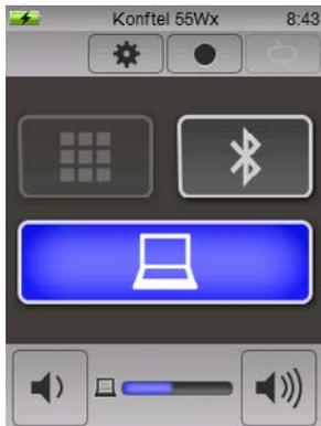
Normalerweise aktiviert der Computer nur den Lautsprecher im Konftel 55Wx, so lange Sie kein Programm starten, das das Mikrofon verwenden kann. Dies bedeutet, dass Konftel 55Wx wie ein Computerlautsprecher funktioniert und dass die Klangverarbeitung durch OmniSound® ausgeschaltet ist. Der Sound wird also direkt übertragen.
